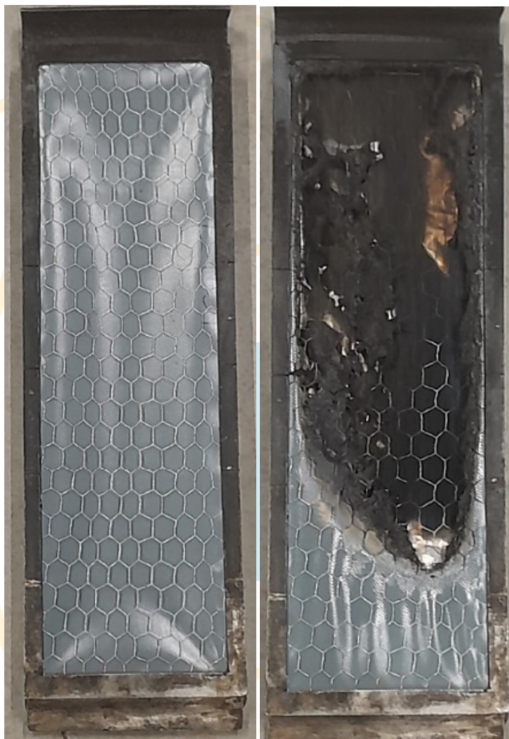
Corpo de prova antes e após o ensaio Determinação do índice de propagação superficial de chama
