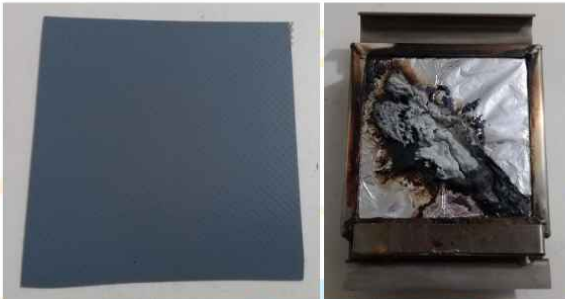
Ensaio de Densidade óptica de fumaça - Amostras antes e após o ensaio
