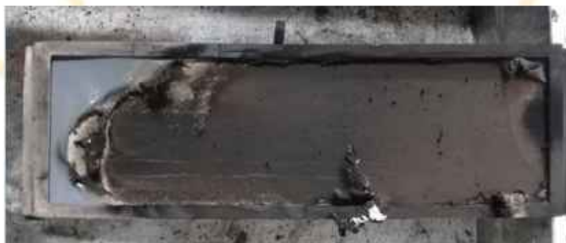
Ensaio de Determinação do Índice de Propagação (Painel Radiante) - Amostra após ensaio
