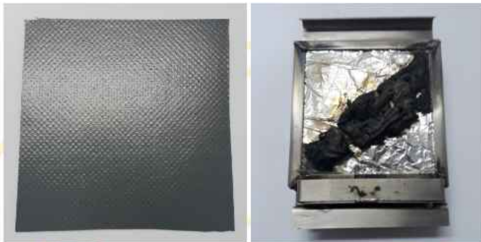
Ensaio de Densidade óptica de fumaça - Amostras antes do ensaio/ após ensaio
