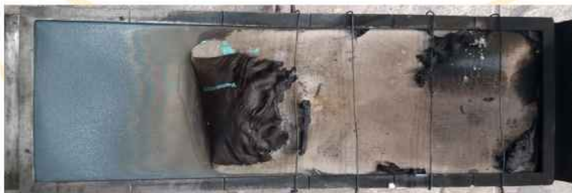
Ensaio de Determinação do Índice de Propagação (Painel Radiante) - Amostra após ensaio
