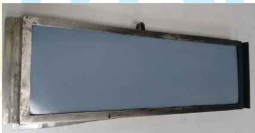
Ensaio de Determinação do Índice de Propagação (Painel Radiante) - Amostra antes do ensaio
