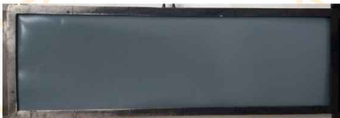
Ensaio de Determinação do Índice de Propagação (Painel Radiante) - Amostra antes do ensaio
